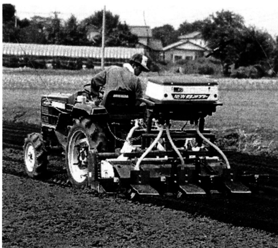
図1. 畝内条施肥機による畦立て同時施肥
